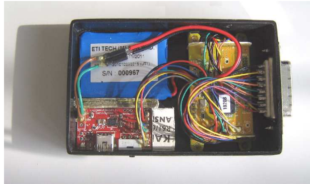
Fig. 2. The disassembled Emotiv Epoc
